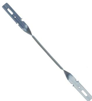
I distanziatori di tipo "G" caratteristici per la loro forma elicoidale alle due estremità, sono studiati per ridurre al minimo la formazione di soffiature o vuoti nel calcestruzzo al di sotto dei distanziatori stessi, riducendo al minimo la possibilità di eventuali infiltrazioni d'acqua attraverso il manufatto.
